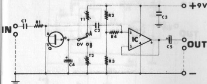
Questo dispositivo, applicato su di una qualsiasi apparecchiatura di riproduzione sonora, serve a variare l'intensità di volume da ZERO al MASSIMO (o viceversa) in modo graduale e del tutto automatico.
